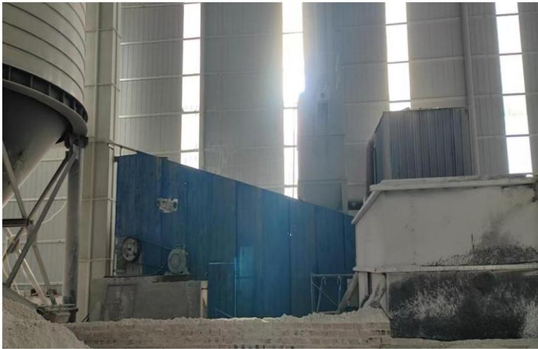
破碎段输送皮带密封
